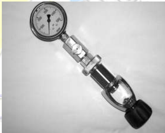
Manometro da superficie
